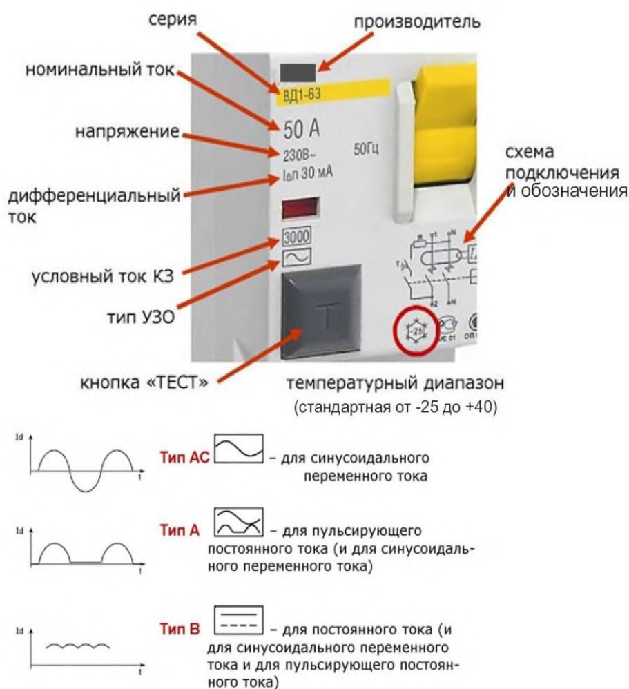
Рисунок 5. Маркировка УДТ
