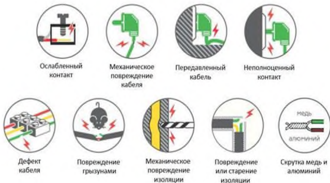
Рисунок 6. Возможные причины искрения в электропроводке
