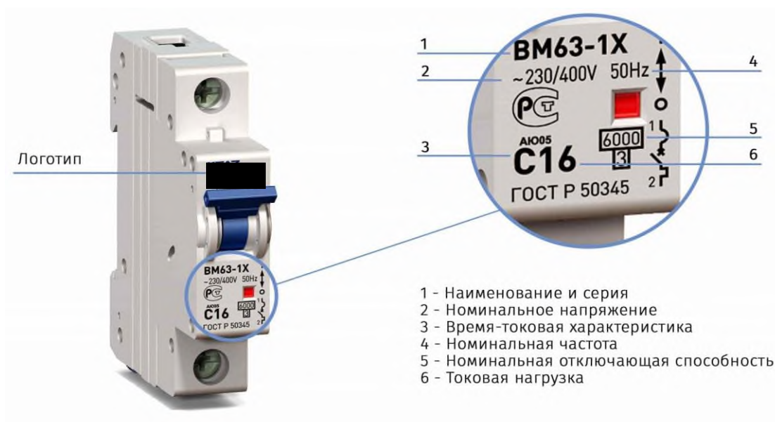
Рисунок 2. Пример маркировки АВ
